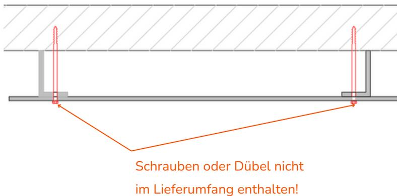
Es wird mit Schrauben oder Dübeln, die durch Löcher in der Oberfläche in die Decke geschraubt werden, befestigt. Die Schraubenköpfe werden durch beiliegende Abdeckungen verdeckt.
